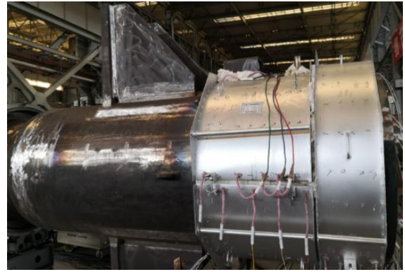
图11 管板-管板筒节消应力装置
